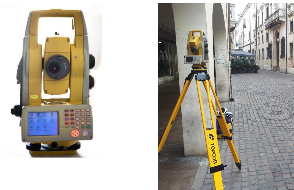
Fig. 2: A sinistra stazione totale Topcon, a destra stazione totale posizionata sul vertice S1
